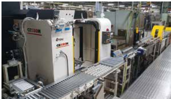
▲船外機用ブロックシリンダ加工ライン
