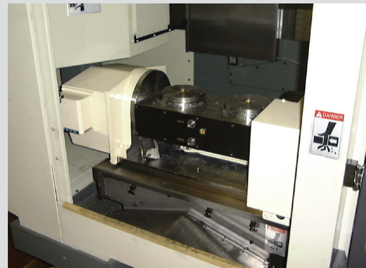
テーブル上にチルト式旋回装置を搭載した例です。 Example of fixture: Tilting device on the table.
