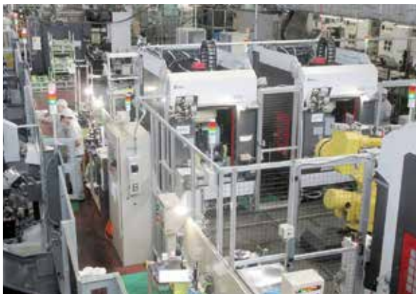
▲当社製マシニングセンタによる自動化ラインにIoT技術を融合して立ち上げた自動車用デフケース新ライン
