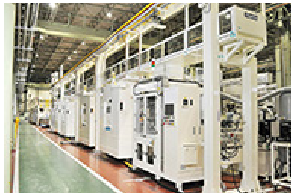
▲シリンダーブロック加工ライン(ガントリー搬送)
