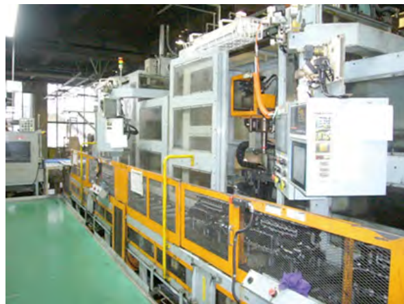
▲小型船舶用ボディシリンダー ホーニング加工工程
