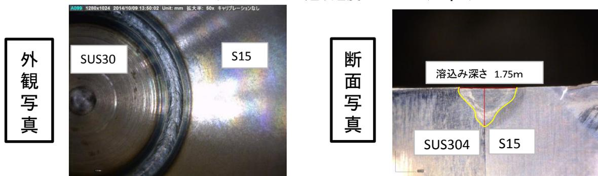
半導体レーザー溶接の特徴は、他のレーザーに比べ溶接幅が広いことです。
