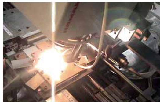
▲高出力半導体レーザーによる精密低ひずみ焼入
