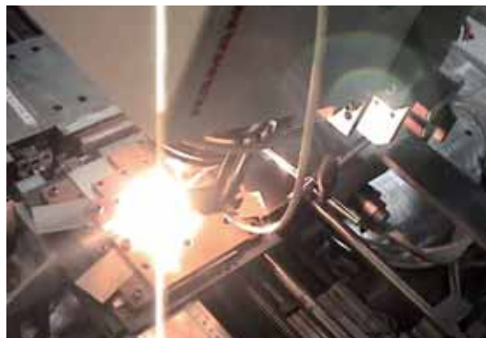
▲高出力半導体レーザーによる精密低ひずみ焼入
